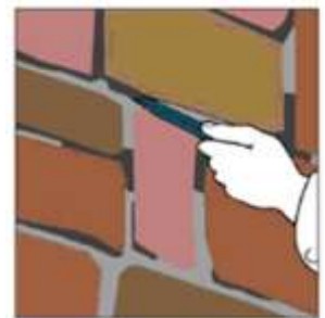
Figura 20. Pregătirea suprafețelor din cărămidă
