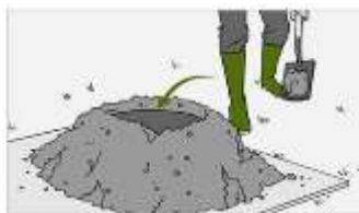
Fig. 16 Prepararea mortarului în mod manual
