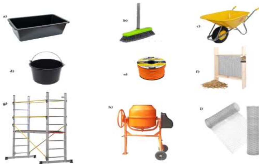
Fig. 5 Dispozitive de lucru și inventar: a) vas pentru mortar; b) mătură perie; c) roabă; d) câldare; e) sfoară pentru trasare; f) sită; g) schelă; h) malaxor; i) plasă răbiț.
