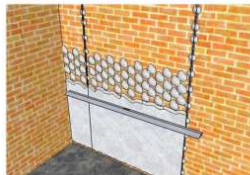
Figura 45. Aplicarea și nivelarea mortarului
